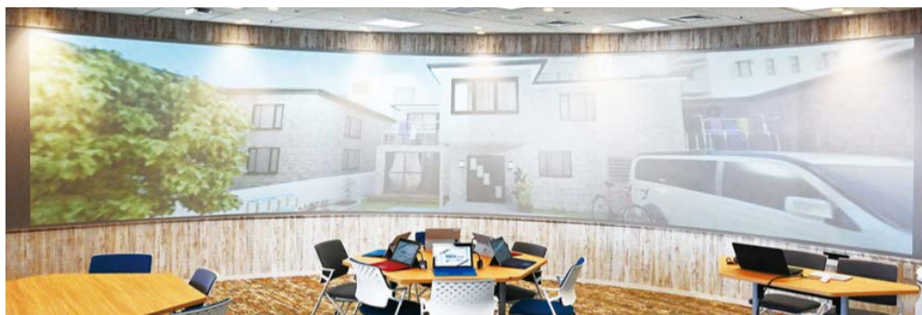
エッジブレンディング映像を曲面大型スクリーンへ投影した様子
