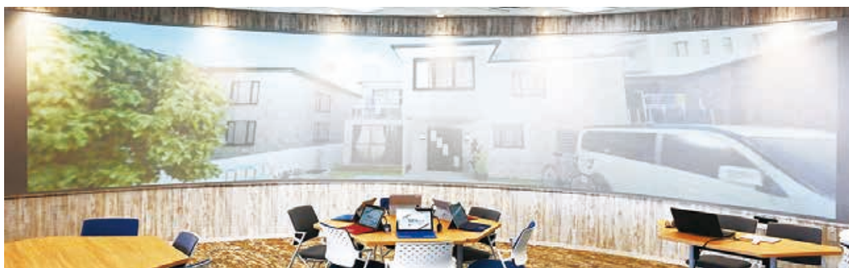
複数台のプロジェクターの画面をつなぎ合わせ、1つのシームレスな映像を作り出す「エッジブレンディング機能」を採用した曲面大型スクリーンの様子
